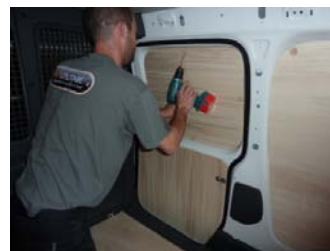
Placez & vissez les parties haute et basse de la porte latérale 9 vis 4x25
