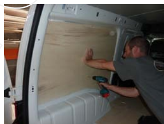
Placez & vissez le côté AR Gauche 8 vis 4x25
