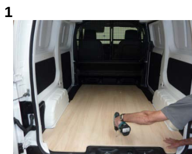
Placez & vissez le Plancher 7 vis 4x25
