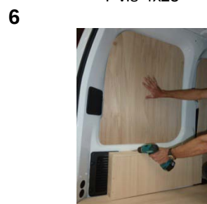
Placez et vissez le passage de roue AR Gauche 4 vis 4x30
