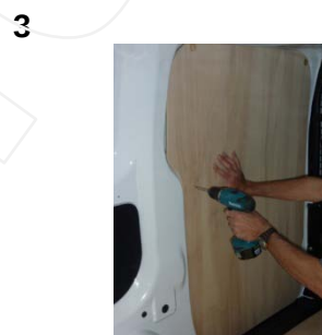
Placez & vissez le côté AV Gauche 7 vis 4x25
