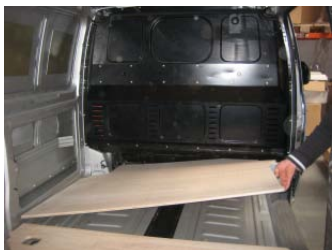
Placez & vissez le Plancher AV 8 vis 4x25
