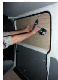
Placez et vissez la porte latérale Parties haute & basse 10 vis 4x25
