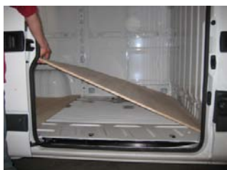
Placez & vissez le Plancher AV 6 vis 4x25
