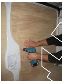
Placez & vissez le côté AV Gauche 12 vis 4x25
