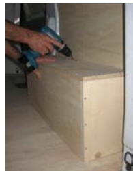
Placez et vissez le passage de roue Droit 5 vis 4x30
