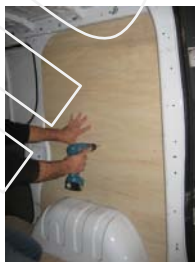
Placez et vissez le côté AR Droit 8 vis 4x25
