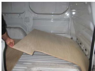
Placez & vissez le Plancher AV 7 vis 4x25
