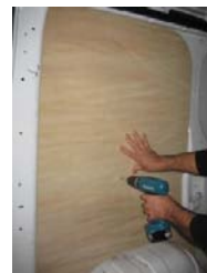
Placez & vissez le côté AR Gauche 8 vis 4x25
