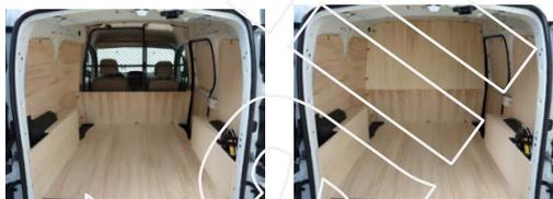
**Double plancher tiroirs face portes arrière / Double plancher tiroir face porte latérale**
