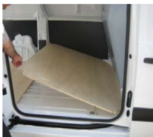
Placez & vissez le Plancher AV 6 vis 4x25
