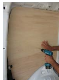
Placez & vissez le côté AR Gauche 4 vis 4x25
