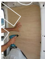
Placez et vissez le côté AR Droit 4 vis 4x25
